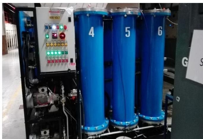
Completato il trasferimento dell'olio dalla cassa principale alla cassa temporanea di stoccaggio, i tecnici Oil-Safe hanno provveduto a staccare il sistema **BULL 500** ed a collegarlo alla cassa di stoccaggio temporanea.
