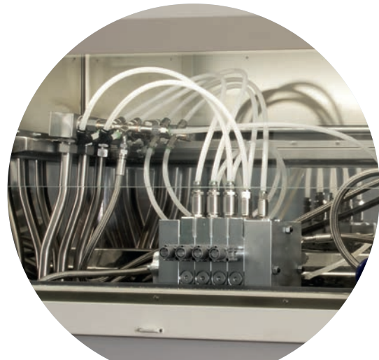
Extraktionssystem durch Druckspülung und interne Spülung
